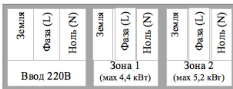
Рис.2 – Обозначение клемных колодок
